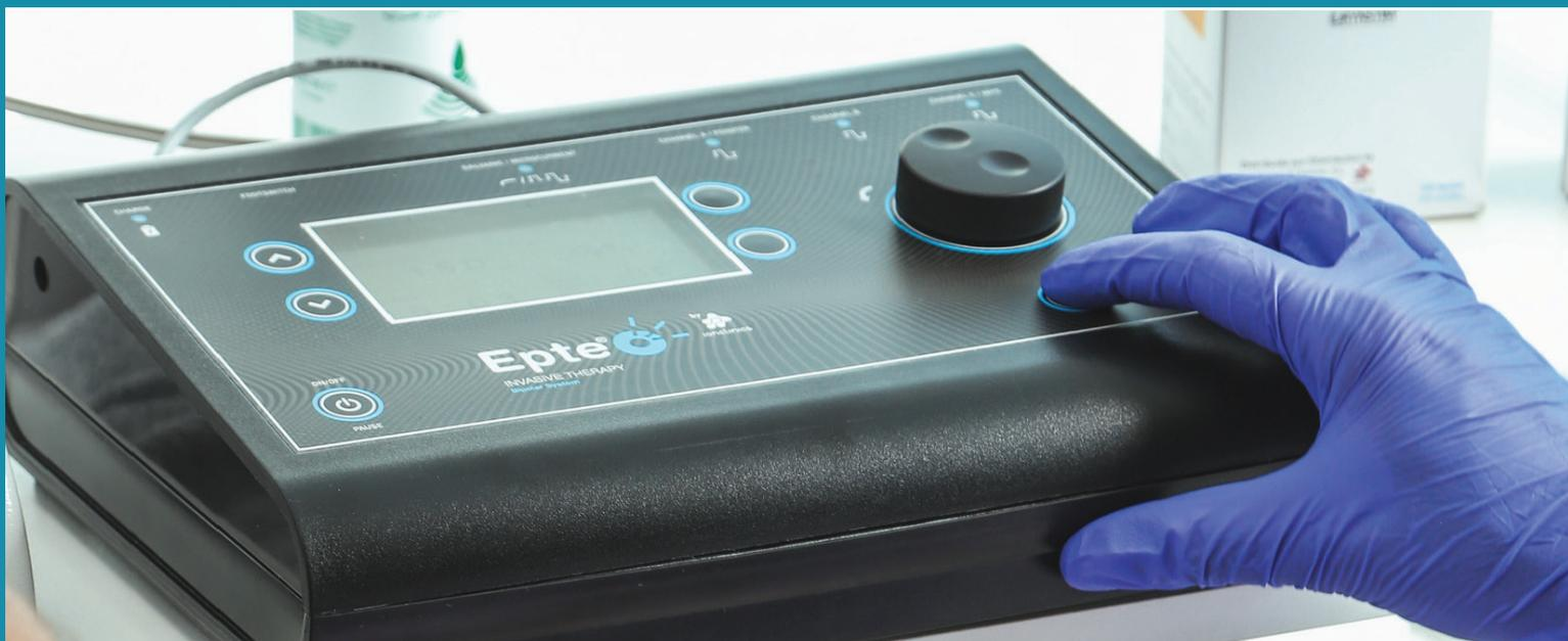
El dispositivo EPTE Bipolar System (EPTEV02V01) se compone de tres fuentes de corrientes (A, B y C) monofásicas/bifásicas, capaces de generar corrientes constantes (galvánicas), corrientes pulsadas monofásicas y bifásicas (simétricas/asimétricas), cuya aplicación es utilizada para distintos tratamientos de patologías del sistema músculo esquelético actuando sobre éste o el sistema nervioso central o periférico dependiendo de la terapia aplicada.
